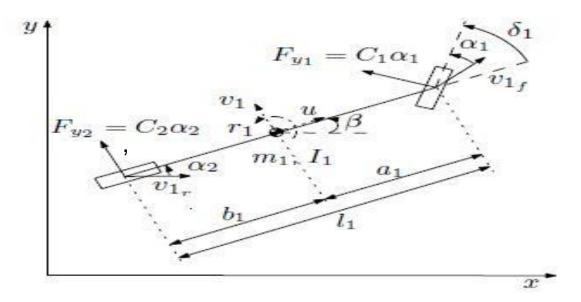
$$\begin{bmatrix} m_1 & 0 \\ 0 & l_1 \end{bmatrix} \begin{bmatrix} \dot{v}_1 \\ \dot{r}_1 \end{bmatrix} = -\frac{1}{u} \begin{bmatrix} C & C_{s_1} + m_1 u^2 \\ C_{s_1} & C_{q_1^2} \end{bmatrix} \begin{bmatrix} v_1 \\ r_1 \end{bmatrix} + \begin{bmatrix} C_1 \\ a_1 C_1 \end{bmatrix} \delta_1$$
